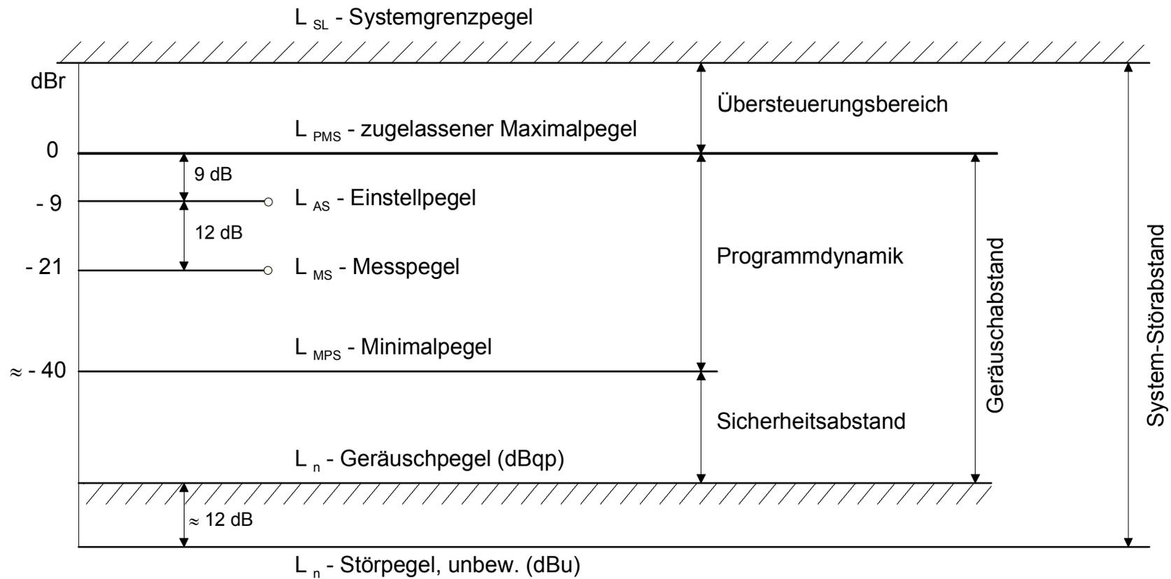
Bild 2.1 **Pegelprofil des Tonkanals**
